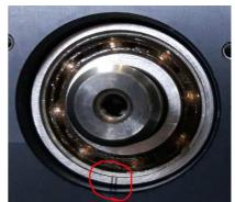
Vergleichsmessungen an einem unbeschädigten Lager (linker, einzeln stehender Lagerbock) und einem Lager mit leichtem, jedoch bereits hörbaren Außenringschaden (Lagerbock rechts außen), jeweils in horizontaler und vertikaler Achse. Der Schaden befindet sich an der unteren, mit einem roten Kreis markierten Position und tritt daher überwiegend in vertikaler Messrichtung auf.
