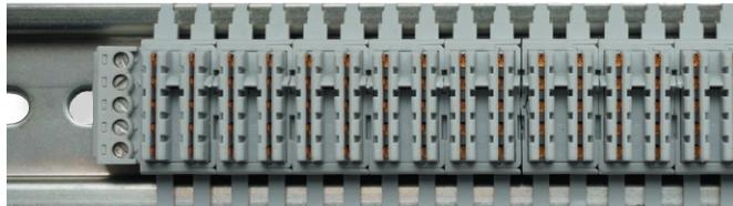
DIN-Schiene mit Bus-Steckern M14-BUS3 und M14-BUS1 (links)
